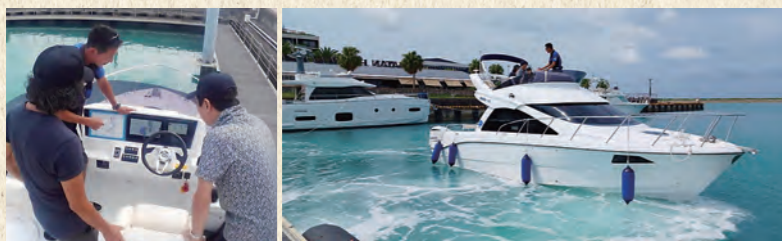
HELM MASTER(ヘルムマスター)講習の様子。船外機操船制御システム「HELM MASTER」は、レバー1本で横方向の移動や360度回転を行えます
