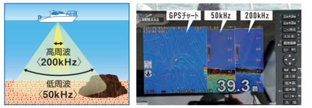
ポイントの絞り込みから停船までの使いこなしをざっくり言ってしまうと、マリーナを出航してから大雑把にポイントを探す時には50kHzの探知結果を参考にし、最終的な停船位置を決める時に
