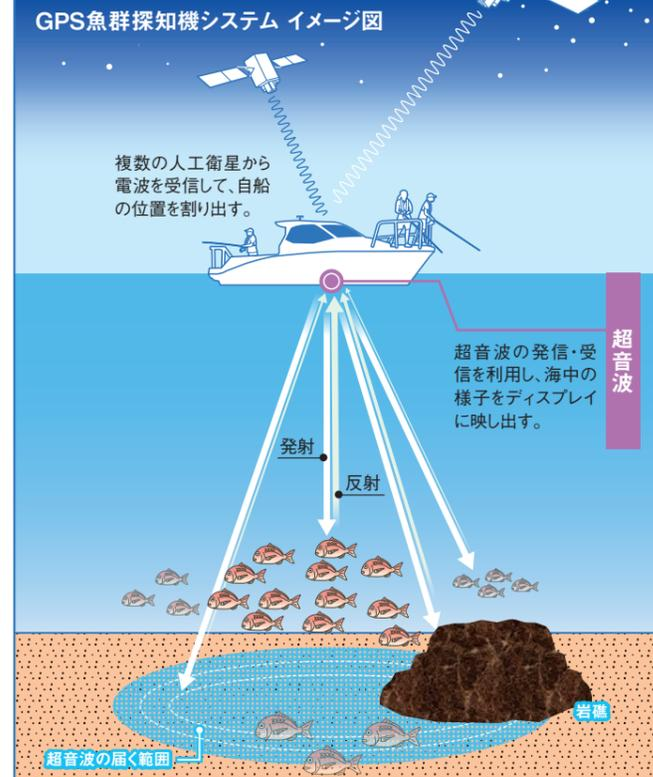
魚探で使用している「音波」は、人間の耳には聞こえない高い振動数をもつ「超音波」です。魚探は、送受波器(振動子)から発射した超音波が海中の反射物(魚群や海底)にぶつかって反射し、再び送受波器に戻るまでの時間を距離に換算してディスプレイに表現する装置、ということになります。海中の最新情報は常にディスプレイの右端縦一列に表示され、順次画面の左側へ移動していきます。
