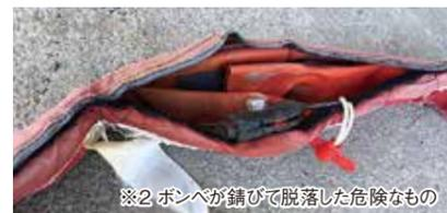
※2 ボンベが錆びて脱落した危険なもの
